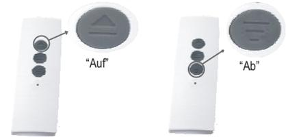
Wird bei diesem Programmierschritt die "Auf"-Taste gedrückt, so wird der Motor, vom Motorkopf aus betrachtet, im Uhrzeigersinn laufen. Drücken Sie dagegen die "Ab"-Taste, so läuft der Motor gegen den Uhrzeigersinn. Dreht der Motor in die jeweils angegebene Richtung, so war das Einlernen erfolgreich.
