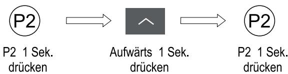
Drücken Sie entweder die "Aufwärts" - oder "Abwärts" Taste für eine kurze Bewegung - entspricht 10° - (loslassen innerhalb von 2 Sekunden). Drücken Sie eine der Tasten länger als 2 Sekunden und der Motor bewegt sich kontinuierlich.
