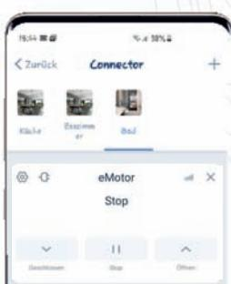
Si vous pilotez un moteur à réglage électronique (choisir le mode E), le curseur ne sera pas opérationnel. Seules les fonctions « Montée/Stop/Descente » sont disponibles.
