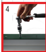
4 Mit einem 17er Ring Schlüssel oder einer Ratsche unter Druck flächig zum Profil einschrauben
