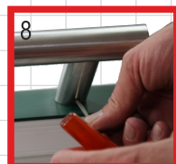
5 Auf der kurzen Seite der Stütze die A2-Madenschraube mit einem Inbusschlüssel Weite 3 anziehen
