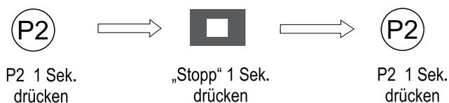
Durch diese Funktion werden die Verbindungen von allen mit dem Motor verbundenen Handsendern gelöscht.
