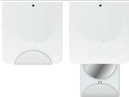
Der Zugang zum Batteriefach befindet sich an der Rückseite (siehe Abb. links). Öffnen Sie das Batteriefach indem Sie dieses mit einem geeigneten Werkzeug durch leichtes drücken und gleichzeitiges Schieben nach unten herausziehen. Die verbrauchte Knopfzelle lässt sich nun entnehmen.
