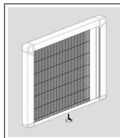
2. Befestigen Sie die Windstopfen in den Kanälen des Bodenprofils
