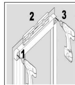
3. Während der Verschraubung von PVC und Fliegengitter sollten diese aufgrund der Reibung gut miteinander verbunden sein, da sonst die Funktion des Fliegengitters beeinträchtigt ist
