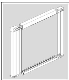
1. Teile gemäß der Abbildung zusammensetzen. Das breite Profil sollte dabei, wie auf der Abbildung angezeigt, oben und das schmale Profil unten angeordnet sein
