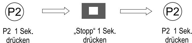
Durch diese Funktion werden die Verbindungen von allen mit dem Motor verbundenen Handsendern gelöscht.
