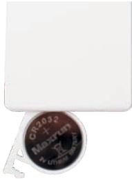
Der Zugang zum Batteriefach befindet sich an der Unterseite des Handsenders (siehe Abb. links). Zwischen Batteriefachdeckel und Gehäuse befindet sich ein kleiner Spalt. Mit einem geeigneten Werkzeug kann der Batteriefachdeckel vorsichtig ein wenig herausgehebelt werden. Das Batteriefach lässt sich jetzt durch eine Drehbewegung vollständig öffnen. Die verbrauchte Knopfzelle lässt sich nun entnehmen.
