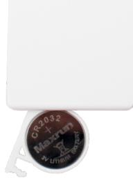
Le compartiment de la batterie se trouve au bas de la télécommande sur la tranche inférieure (voir illustration à gauche). Il y a une encoche entre le couvercle du compartiment à batterie et le boîtier de la télécommande. Utilisez un outil adapté pour soulever prudemment le couvercle. On peut alors ouvrir totalement le compartiment par un mouvement rotatif. Vous pouvez ensuite retirer et remplacer la pile bouton.
