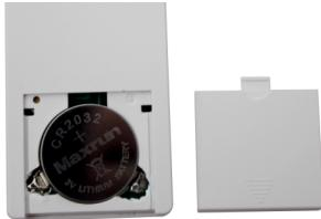
Le compartiment de la batterie se trouve sur la face arrière de la télécommande (voir illustration à gauche). Faites coulisser le capot vers le bas. Vous pouvez retirer et remplacer la pile bouton.
