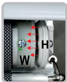
Ihr elektrisches Fensterrollo wird komplett montiert im Gehäuse (G) geliefert. Für die Montage müssen Sie zuerst den mit einem Motor ausgestatteten Behang (B) aus dem Gehäuse (G) entfernen.
